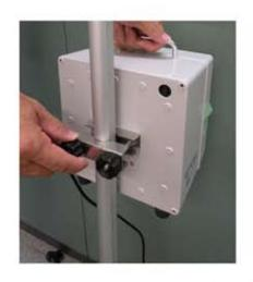
専用の三脚に取り付けると上下に 移動させることが出来ます。 調節は後ろのネジを緩めてカメラ を適当に高さにセットしてネジを 締めるだけで行えます。
